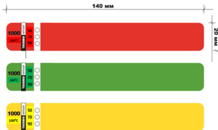
Рисунок 4.1 - Эскиз термоактивируемых газовыделяющих наклеек ТГН-100-1000-Ж(З,К)-50/70/90
