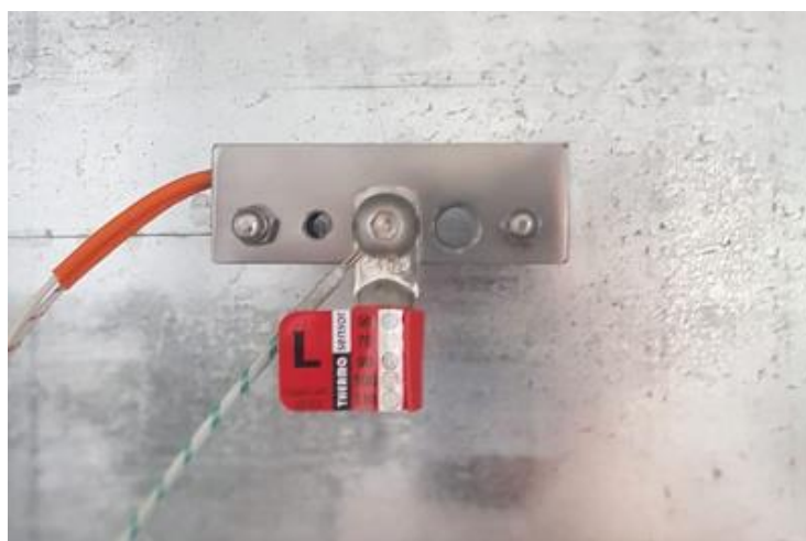
Рисунок 4.3 – Способ размещения ТГН на модели контактного соединения.
