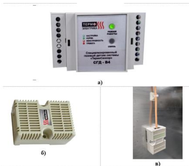
Рисунок 4.2 - Внешний вид датчика СГД: а) основной корпус датчика; б) корпус выносного чувствительного элемента; в) пример крепления выносного чувствительного элемента в высоковольтном отсеке.
