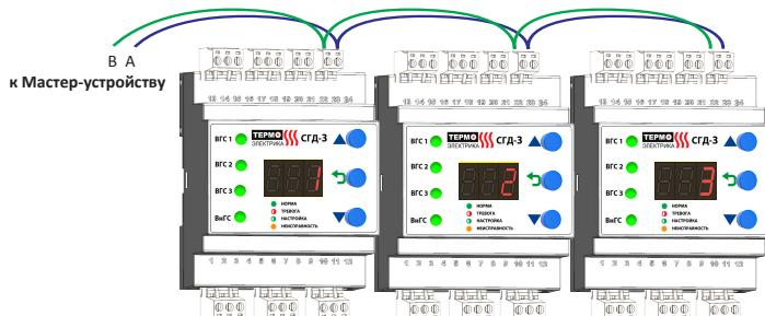
В случае ошибочного подключения линии питания к линии связи приемо-передатчику RS-485 могут выйти из строя. В связи с этим перед подачей питания рекомендуется убедиться в правильности подсоединения всех датчиков.
