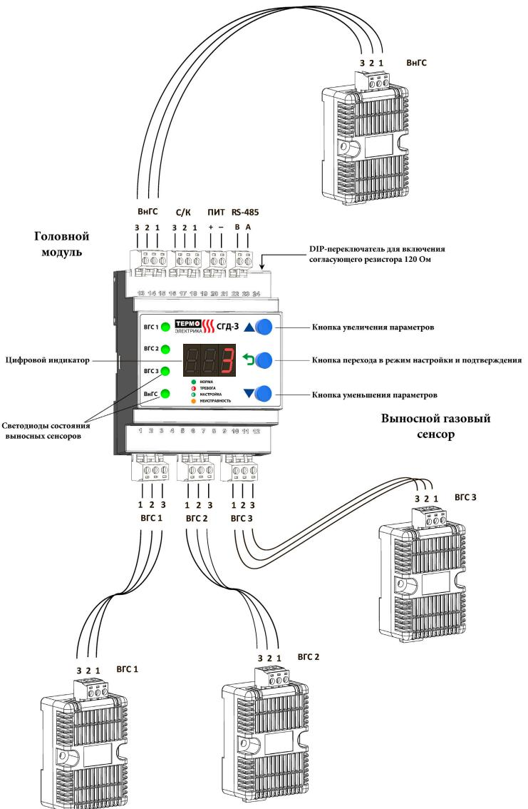
Разъемы ВГС 1, ВГС 2, ВГС 3, ВнГС совпадают с разъемами выносных газовых сенсоров и подключаются по схеме: 1 – «», 2 – сигнал (S), 3 – «+».
